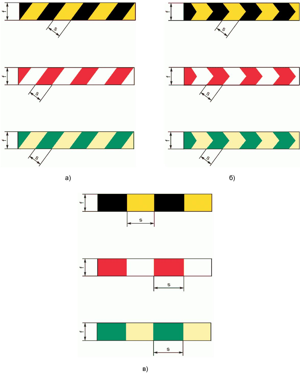
а) - расположение полос наклонно; б) - расположение полос зигзагообразно в виде "елочки"; в) - расположение полос прямо (вертикально или горизонтально),  $f$  - поперечный размер сигнальной разметки,  $s$  - ширина полосы сигнального цвета.
