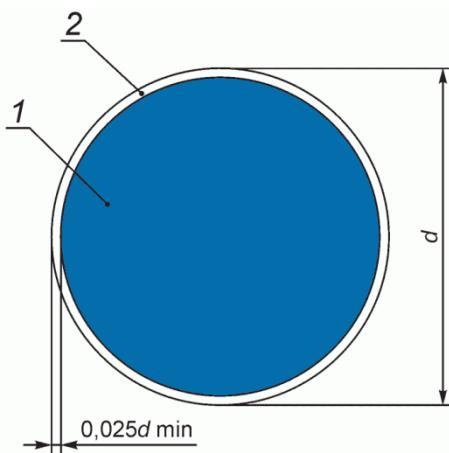
d - диаметр круга; 1 - основная поверхность; 2 - кант
